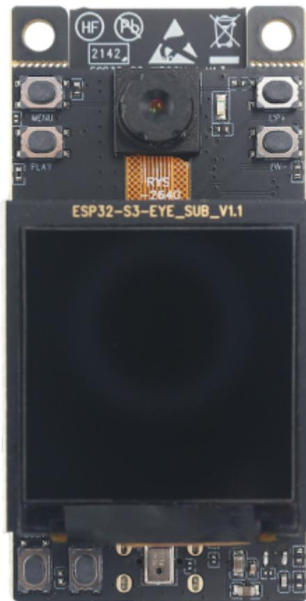
La carte ESP32-S3-EYE se compose de deux parties : la carte principale (ESP32-S3-EYE-MB) qui intègre le module ESP32-S3-WROOM-1, la caméra, l'emplacement pour carte SD, le microphone numérique, le port USB et la fonction boutons; et la sous-carte (ESP32-S3-EYE-SUB) qui contient un écran LCD. La carte principale et la sous-carte sont connectées via des embases à broches.
