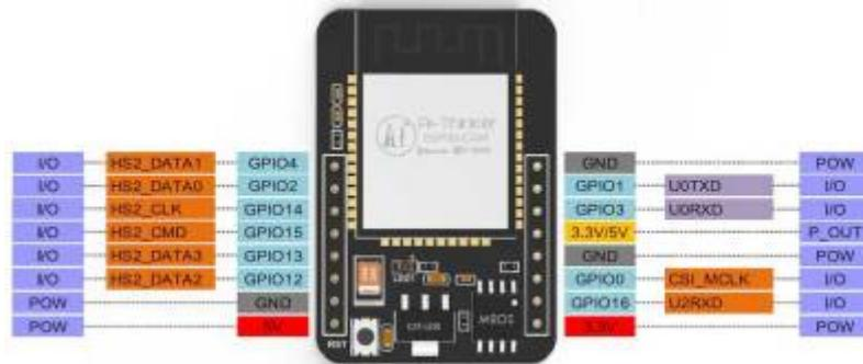
**Le raccordement des broches TX et RX , doit être vérifié , le schéma indique un branchement croisé entre l'ESP-Cam et USB-Serie ce qui veut dire : TX ESP (GPIO1) sur RX série et RX ESP (GPIO3) sur TX Série**
