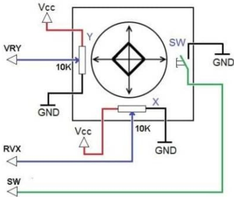
L'image ci-dessus montre une représentation électrique d'un joystick à deux axes. Vous pouvez également voir l'option de commutation.
