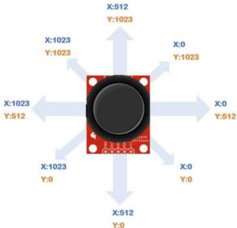
Les deux potentiomètres tournent automatiquement au ralenti en position centrale. Cela signifie que la valeur lue sera la moitié de la résolution maximale de l'ADC.
