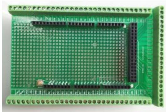
[Sheild raccordement à vis arduino Méga](#)
