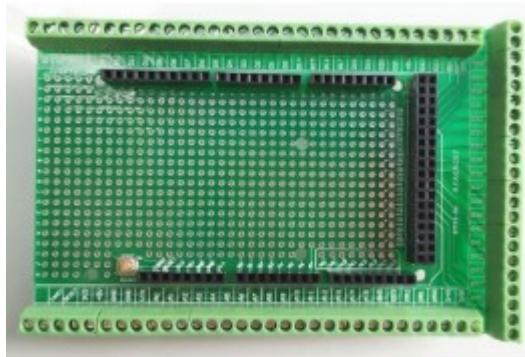
Sheild raccordement à vis arduino Méga
