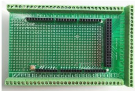
[Sheild raccordement à vis arduino Méga](#)
