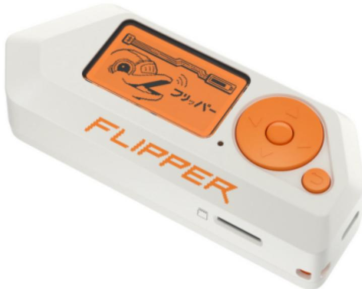
Le Flipper Zero est le multi-outil ultime pour les pentesters, les geeks, les hackers éthiques et les amateurs de matériel informatique. Un seul appareil de poche combine plusieurs outils : RFID, RF, Infrarouge, émulation HID, GPIO, débogage matériel, 1-Wire, Bluetooth, Wifi et plus encore.
