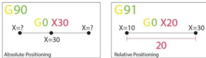
Les commandes G90 et G91 indiquent à la machine comment interpréter les coordonnées utilisées pour le mouvement. G90 établit le "positionnement absolu", qui est généralement la valeur par défaut, tandis que G91 est pour le "positionnement relatif". Aucune des deux commandes ne nécessite de paramètres, et la définition de l'une annule automatiquement l'autre.
