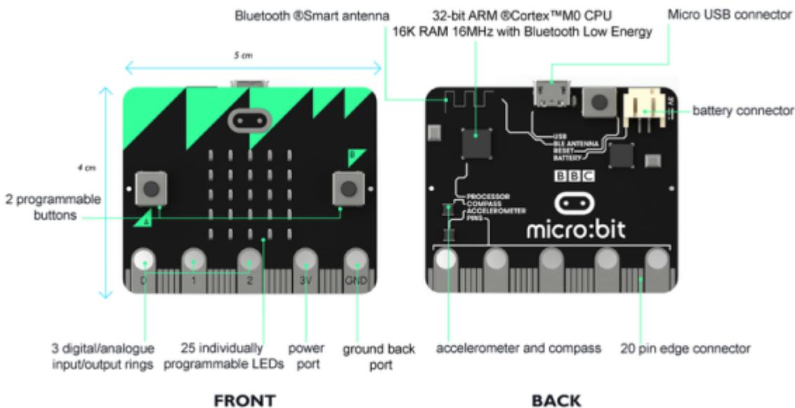
Ton micro:bit dispose des spécificités techniques suivantes :
