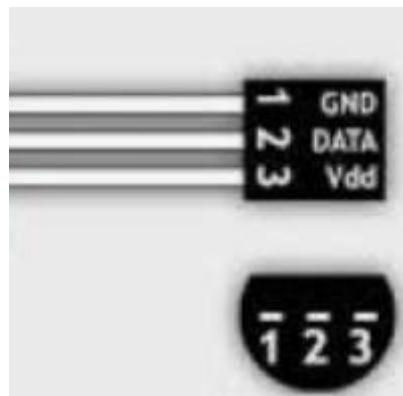
un “trois pattes” digital en connexion bus **I2C** connecté sur le GPIO 4 de l'**ESP32**. Il sera placé en partie haute de la ruche
