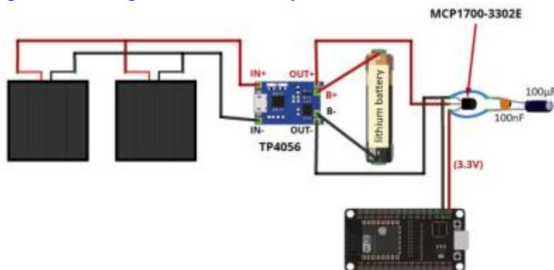
Dans une version future, la pile sera branchée également sur une GPIO de l'ESP32 afin de mesurer le pourcentage de charge et de l'envoyer également comme donnée afin d'anticiper le changement de cette pile.
